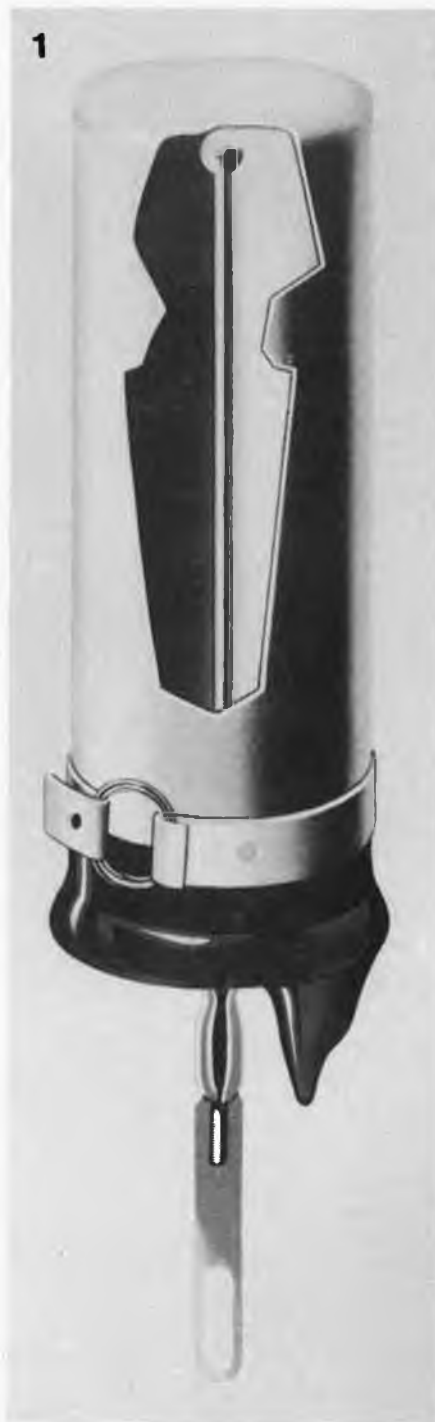
Photo 1. Vue en coupe d'un tube compteur à armature. On distingue nettement l'électrode interne (anode). Le cylindre métallique (armature) forme la cathode du compteur.
