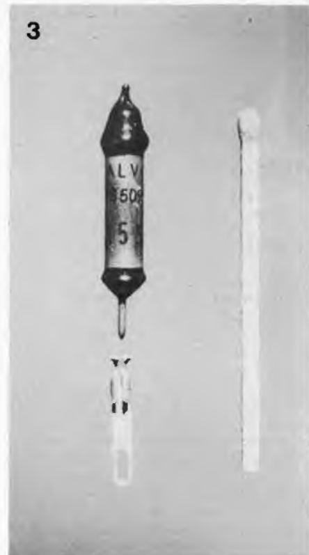
Photo 3. Tube compteur à armature (miniature) 18509 (ZP 1310) comparativement à la hauteur d'une allumette.
