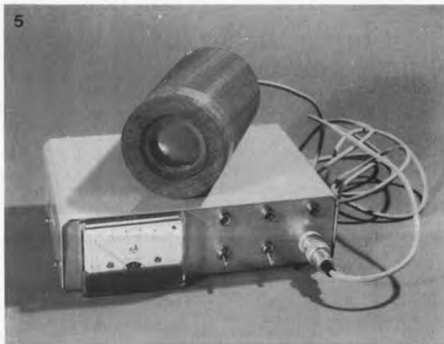
Photo 5. Vue du prototype. Le tube est séparé du circuit électronique et se trouve logé dans une enveloppe protectrice (compteur sonde). Il est relié au boîtier du circuit par un câble et une fiche coaxiale. Les trois inverseurs de la face avant permettent les communications suivantes: Marche/Arrêt, Pile/Réseau, Choix de la gamme de mesures.
