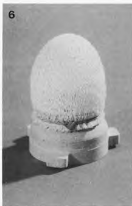
Photo 6. Préparation radioactive destinée au contrôle du compteur Geiger; c'est tout simplement un manchon à gaz vendu dans n'importe quel magasin d'accessoires de camping.
