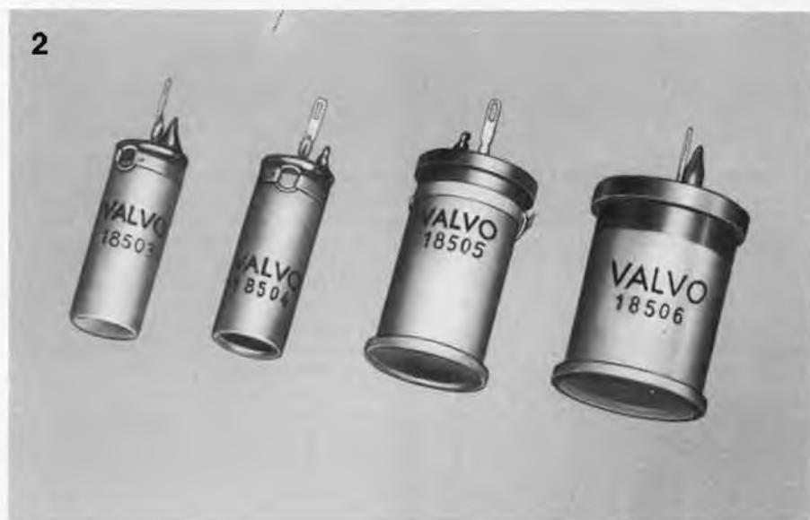
Photo 2. Différents tubes pour compteur Geiger-Müller. De la gauche vers la droite: Tube à armature 18503 (ZP 1200), même modèle mais équipé d'une fenêtre 18504 (ZP 1400), puis deux autres types à fenêtre ayant une sensibilité élevée.
